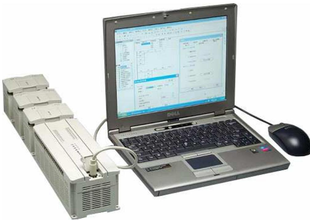
图1-4 编程电缆连接
