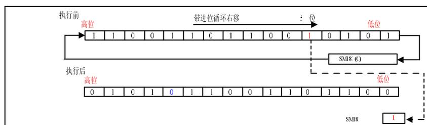
当 M0=ON 时, D0=2#1100110110010101 (52629) 带进位 (SM181=OFF) 循环右移 5 位, 结果赋给 D10, D10=2#01011001101100 (22124), SM181=ON。
