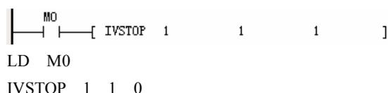
1. 设置串口 1，变频器地址 #1，以及变频器的停止方式 0（按设定的减速时间停车），通过 Modbus 通讯协议控制变频器的停止。
