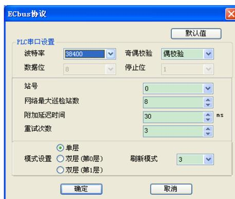
如上图所示设置 N:N 参数。**站号**的设置应该从 0 号开始，依次设置，不能将多台 PLC 设置为同一站号。0 号站是网络的启动和设置站点。**网络最大巡检站数**、**附加延迟时间**、**重试次数**、**模式设置**等参数只需要对 0 号站进行设置。其它站号的站点除了波特率和奇偶校验要与 0 号一致外，只需设置自己的站号，如下图所示：
