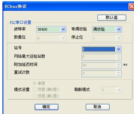
**网络最大巡检站数**指网络中一共使用的 PLC 总数。如果一共使用 6 台 PLC，请将其设为 6，同时将这 6 台 PLC 的站号设为 0~5 号。如果希望在网络不中断的情况下，将来在网络中加入 2 个新的 PLC，可以将网络最大巡检站数设为 8，将来加入的 PLC 站号分别设为 6 号和 7 号，那么当 6 号和 7 号接入网络时，会被 N:N 在 1 秒内自动的检测到，并纳入到与 0~5 号的数据交换中。
